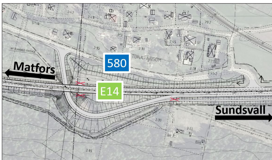
Figur 5.2:3 Utformning korsning Vattjom Östra
