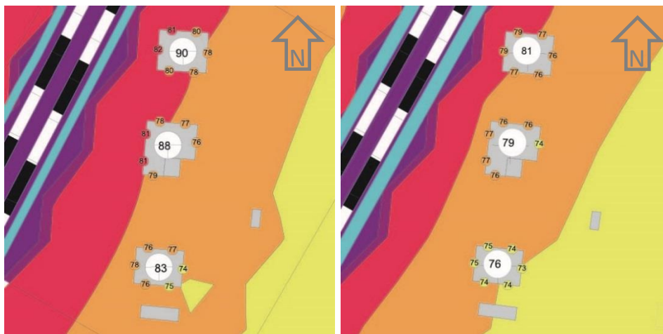
Figur 4 Exempel på skillnaden i ljudutbredningsnivå (maxnivå) på några hus i norra Ödåkra mellan tre meter hög skärm till vänster och fem meter hög skärm till höger. Effekten är stor på plan två (värden i vita cirklar mitt på husen) men begränsad vid fasad i markplanet.
