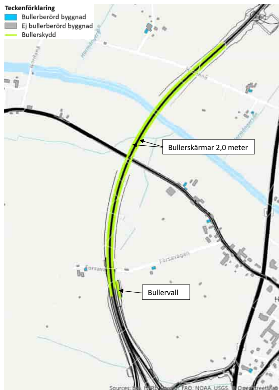
Figur 8.2.4 Vagnära stänk- och bullerskydd i Harmångersdalgången.
