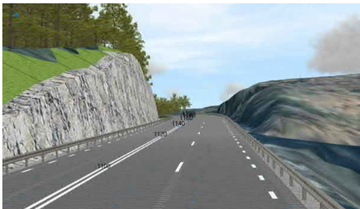
Figur 12. Urklipp från vägmodell vid bergskärning, körfältsindelning för stigningsfält.
