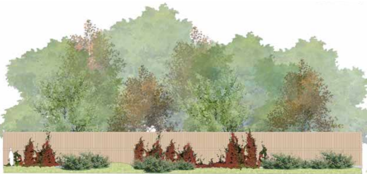
Bild 46. Principskiss utformning bullerskyddsskärmar längs vegetationsridåer och i öppet landskap, här med förslag på vegetation framför
