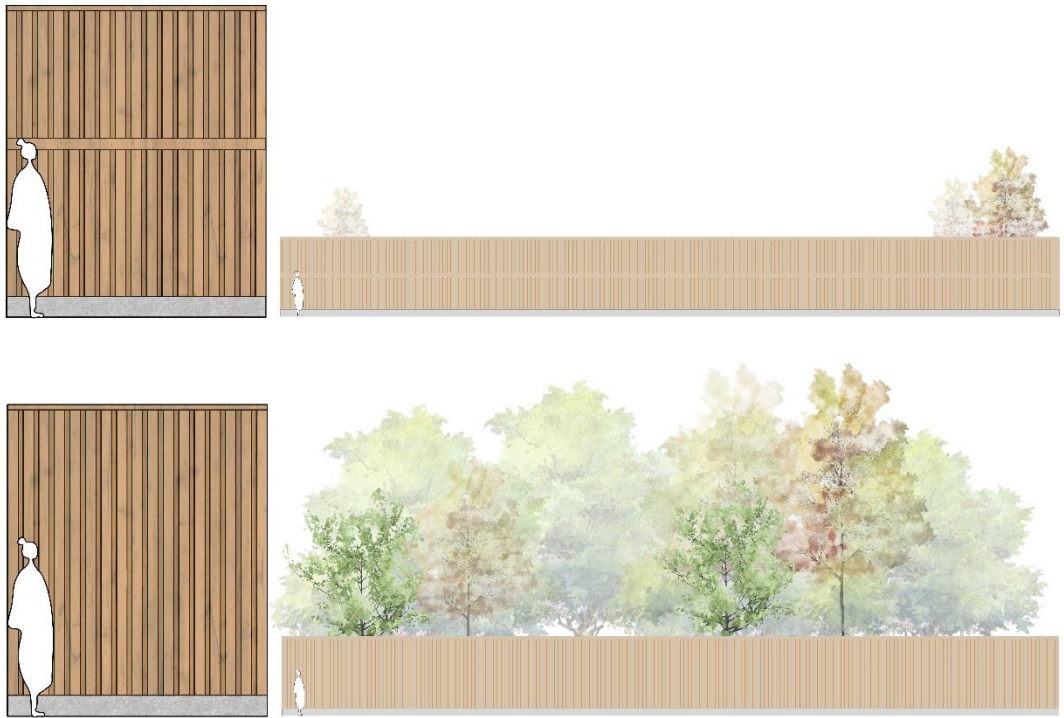
Figur 19. Föreslagen utformning av vägnära bullerskyddsskärmar i landskapet.
