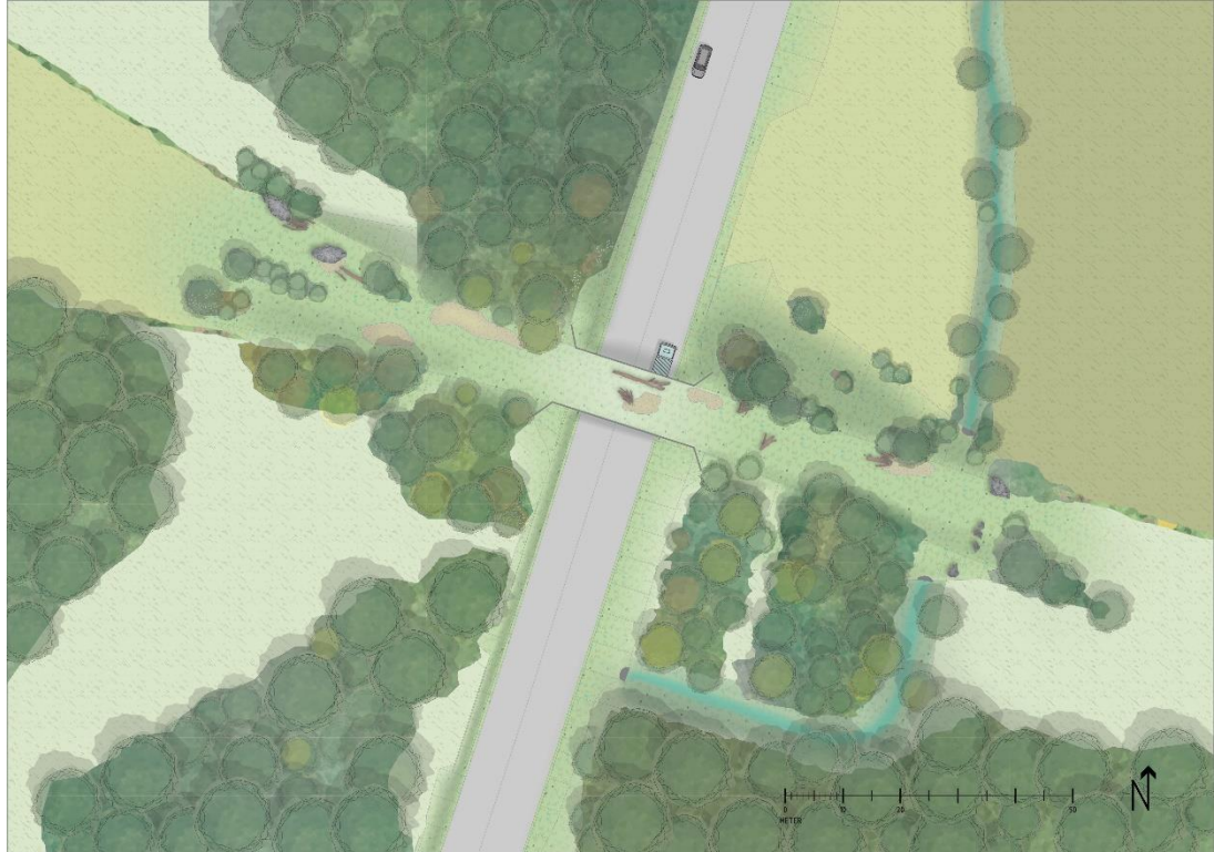
Figur 27. Exempel på utförande av faunapassage.
