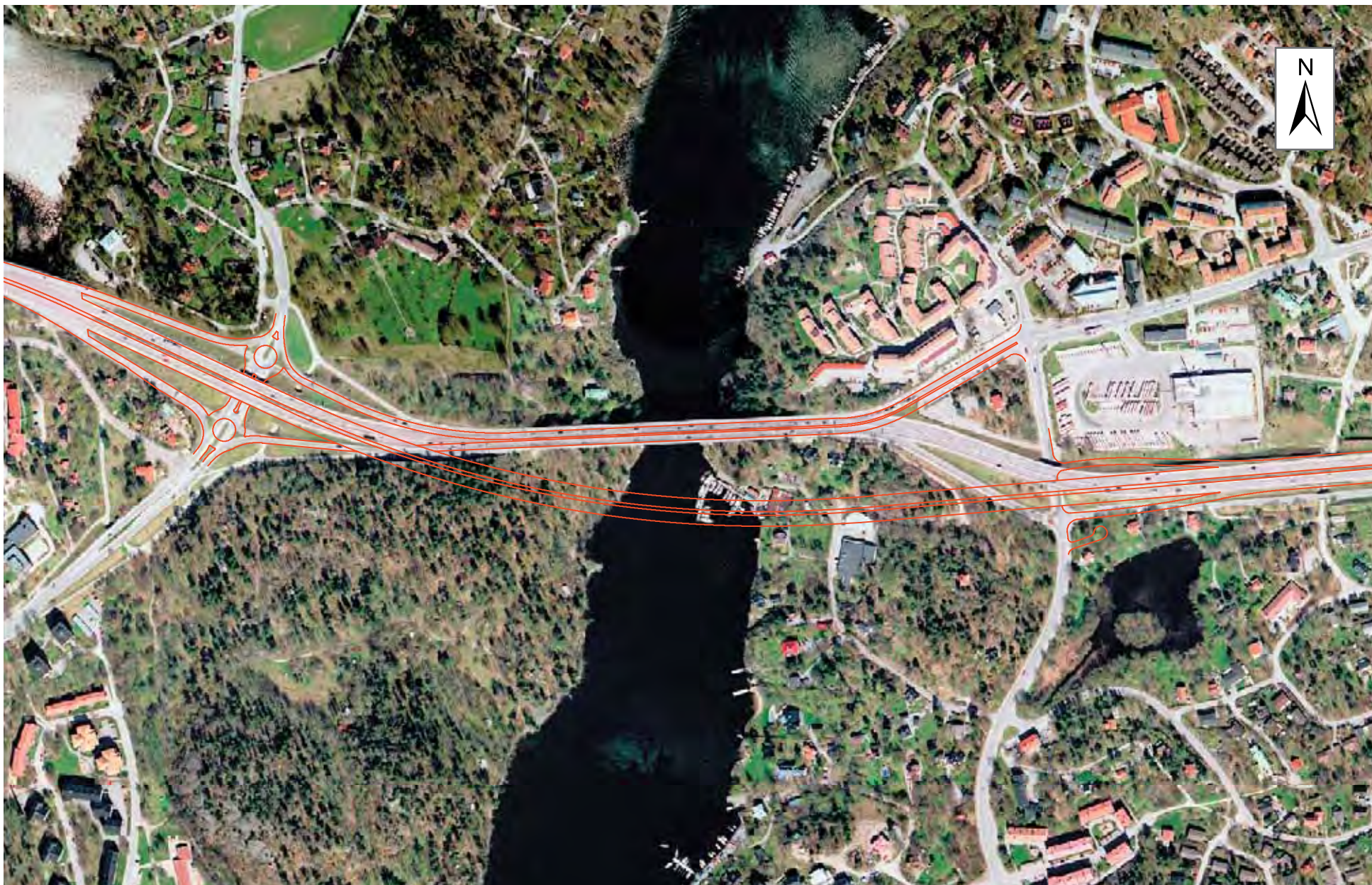
Ny friliggande bro och en ofullständig trafikplats i Skuru med ramper i riktning mot Stockholm samt en ofullständig trafikplats i Björknäs med ramper i riktning mot Värmdö
