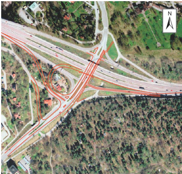
Figur 2: Principutformning av ny påfartsramp i Skuru.
