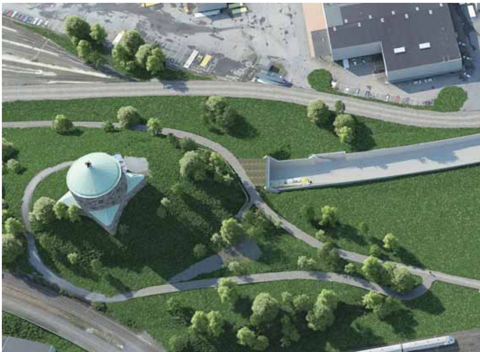
FIGUR 4.38. Illustrationsexempel i fågelperspektiv över Gullberget, tunnelmynning, tråget och broarna över E6. Cykellederna löper från centrum och öster ut, dels via Kruthusgatan och vidare på GC-bro längs Västlänkens bro över E6 och
