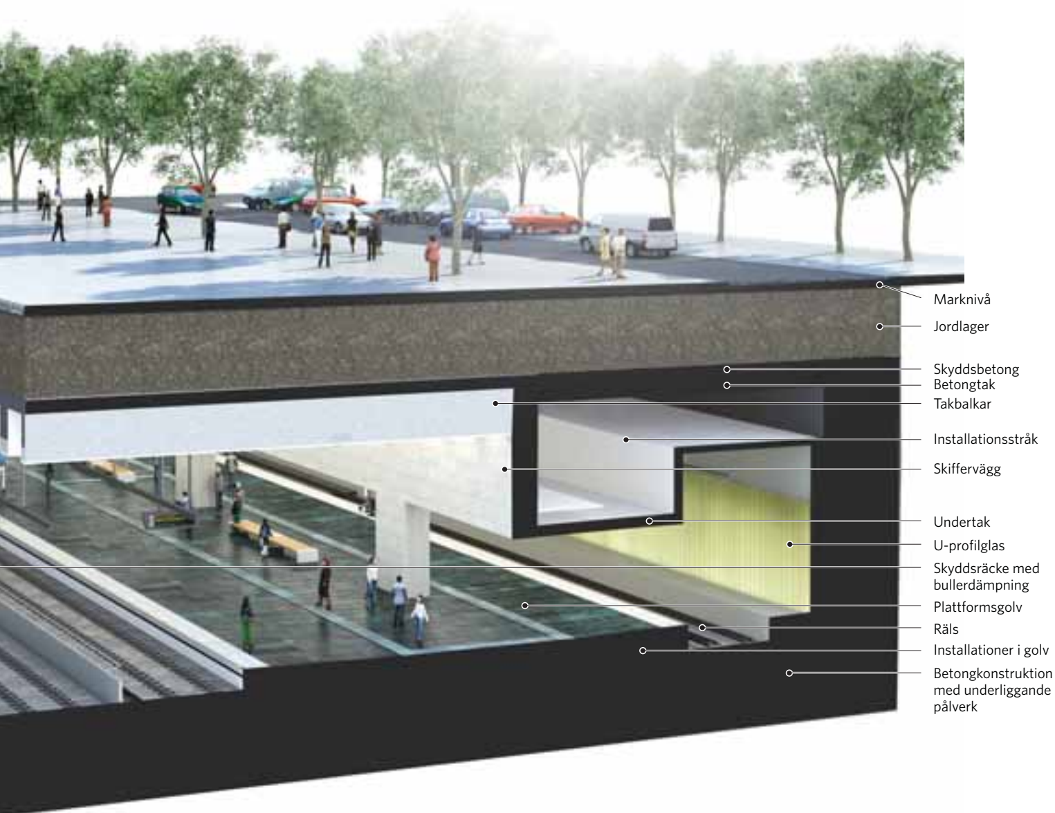
FIGUR 5.27. Här visas stationsrummet under mark som en utskuren sektion där även en del av taket är avlyft för att visa pelarraden och plattformen. Man ser tydligt de två plattformarna med sina pelarrader som blir solida väggar upp mot takbalkarna i mittskeppet.
