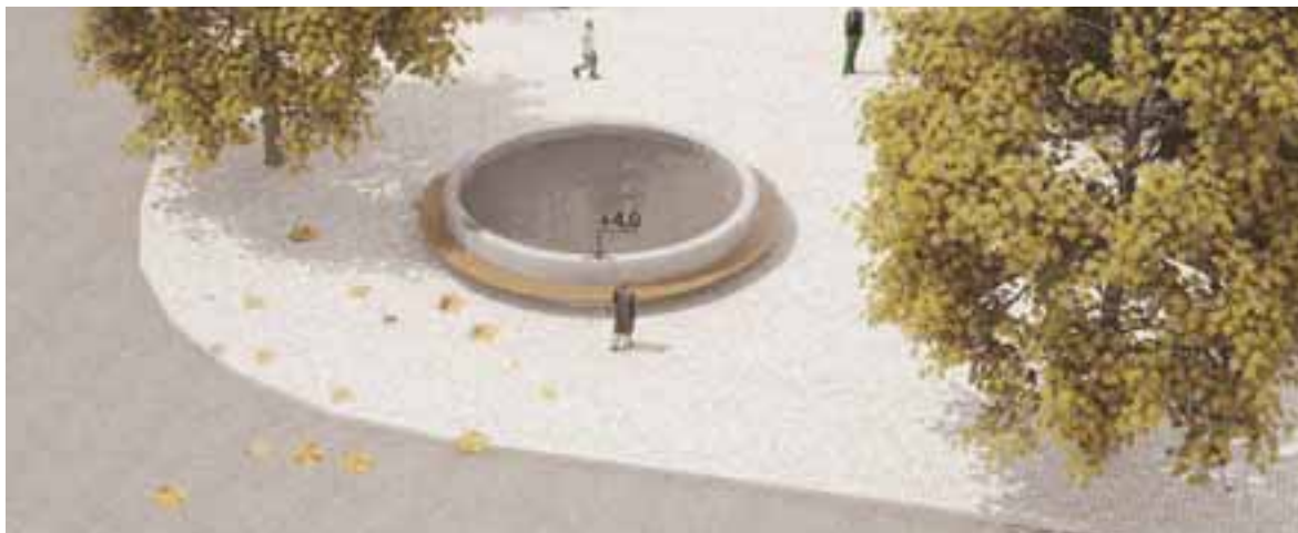
FIGUR 5.39. Illustrationsexempel som visar överbyggnad för brandgasschakt i gångstråk. Förslaget bidrar till platsens funktion genom att sittplatser placeras vid den massiva granitmuren.
