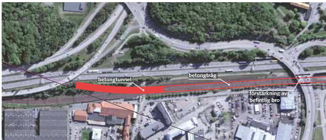
FIGUR 7.64. Situationsplan Almedal. Betongtunneln är markerad med helrött och tråget med röda linjer. Längst till höger ser man den befintliga vägbron som behöver förstärkas med hänsyn till påkörningskrafter.
