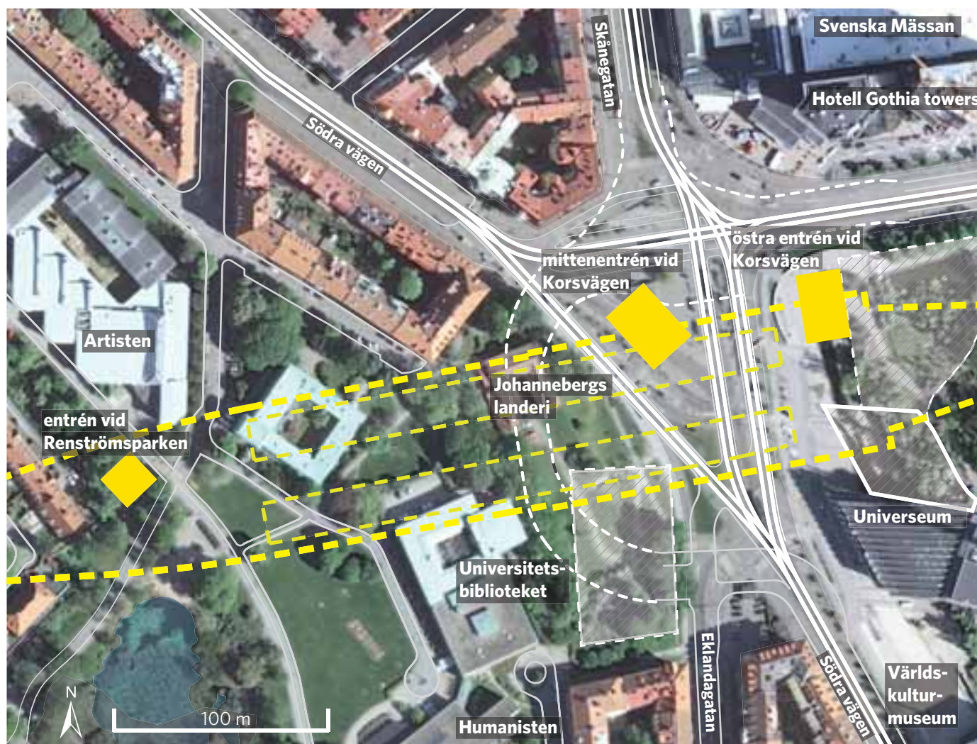
FIGUR 7.36. Situationsplan. Streckad vit linje visar läge för eventuell framtida vägtunnel som staden planerar. Snedstreckat område omgivet med heldragen vit linje visar befintlig byggrätt. Snedstreckade ytor omgivna med streckad vit linje markerar områden som eventuellt kan bli aktuella för byggnation.
