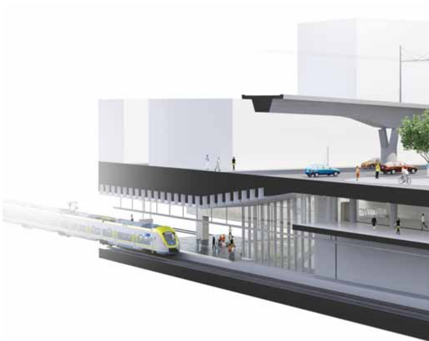
FIGUR 5.36. Illustrationsexempel som visar västra uppgången med sitt mellanplan som en utskuren sektion. Man ser en av den planerade nya Hisingsbrons ramper genomskuren ovanför mellanplanet. Längre bort i bild ligger Nordstan med södra entrén framför.
