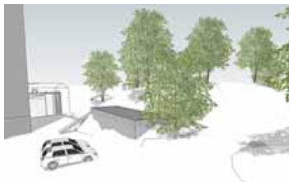
FIGUR 6.41. Illustrationsexempel som visar tryckutjämningschakt Fogelbergsparken.
