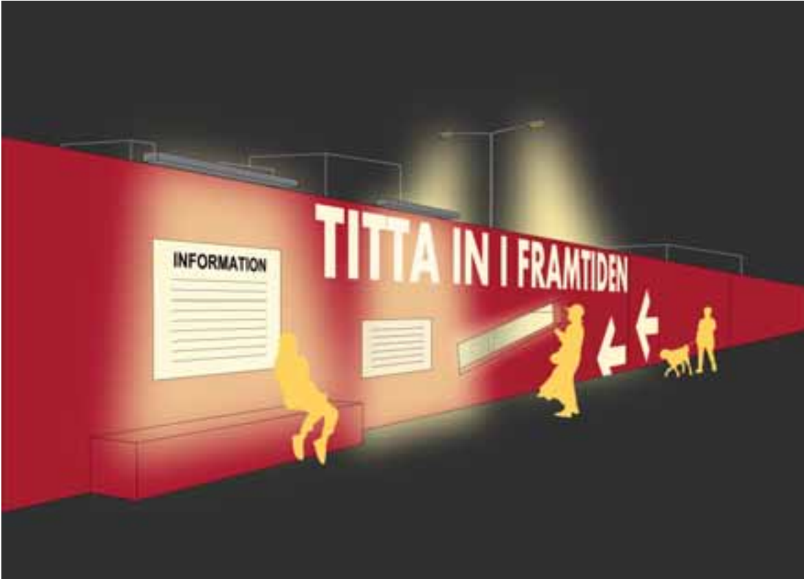
FIGUR 8.30. Illustrationsexempel. Byggplatsen kan belysas nattetid. En bra belysning kan fästas på avskärmningarna för att lysa upp information och göra passager eller gångstråk tryggare.
