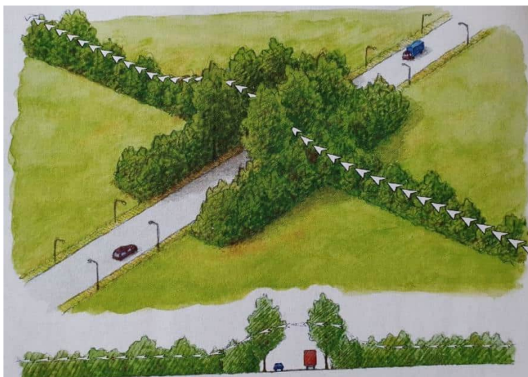
Figur 9. Bilden visar hur man kan utforma en s.k. hop-over för att underlätta för fladdermöss att flyga över vägen och minska barriärpåverkan. Av Peter Twisk.
