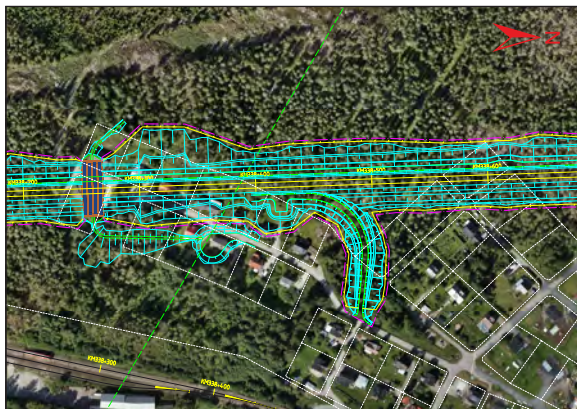
Figur 4.7:9 Bortvald utformning Serviceväg 1 Vapelnäs.
