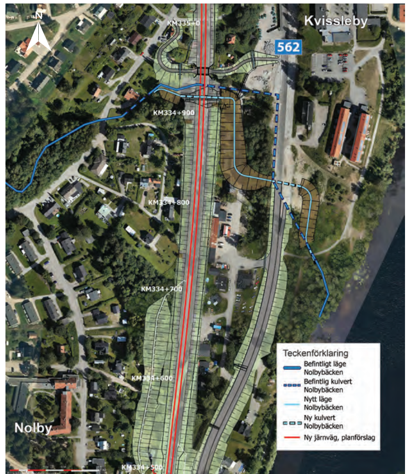
Figur 6.3:28 Befintlig och planerad omläggning av Nolbybäcken.
