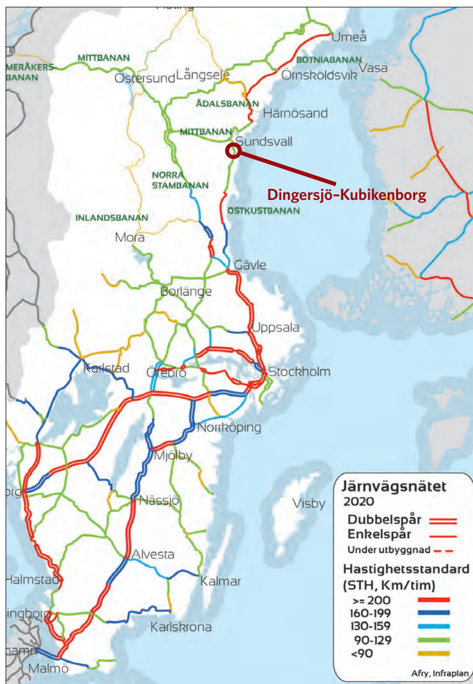
Figur 5.1:2 Ostkustbanan är enkelspårig och har delvis låg hastighetsstandard och bristande kapacitet.
