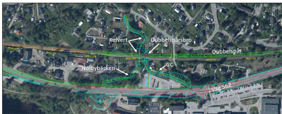
Figur 6.8:5 Avfört alternativ. Innebär, i den norra delen, att Nolbybäcken behöver kulverteras på två platser (vid dubbelspåret och vid gång- och cykelväg), vilket inte är i linje med ambitionen att "öppna upp" så mycket som möjligt av bäcken.
