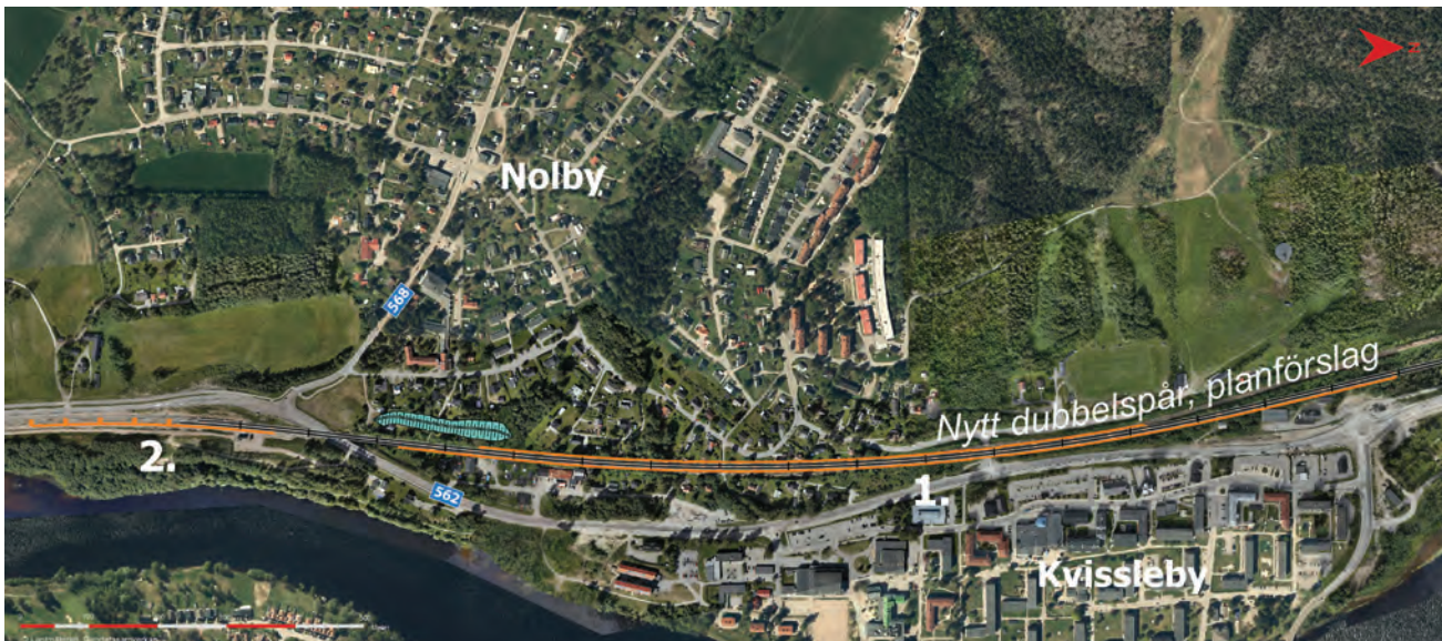
Figur 8.6:5 Illustration över föreslagna källnära åtgärder för Nolby, Kvissleby och Skottssund. Orange markering visar bullerskyddsskärm, blå markering visar bullerskyddsvall.
