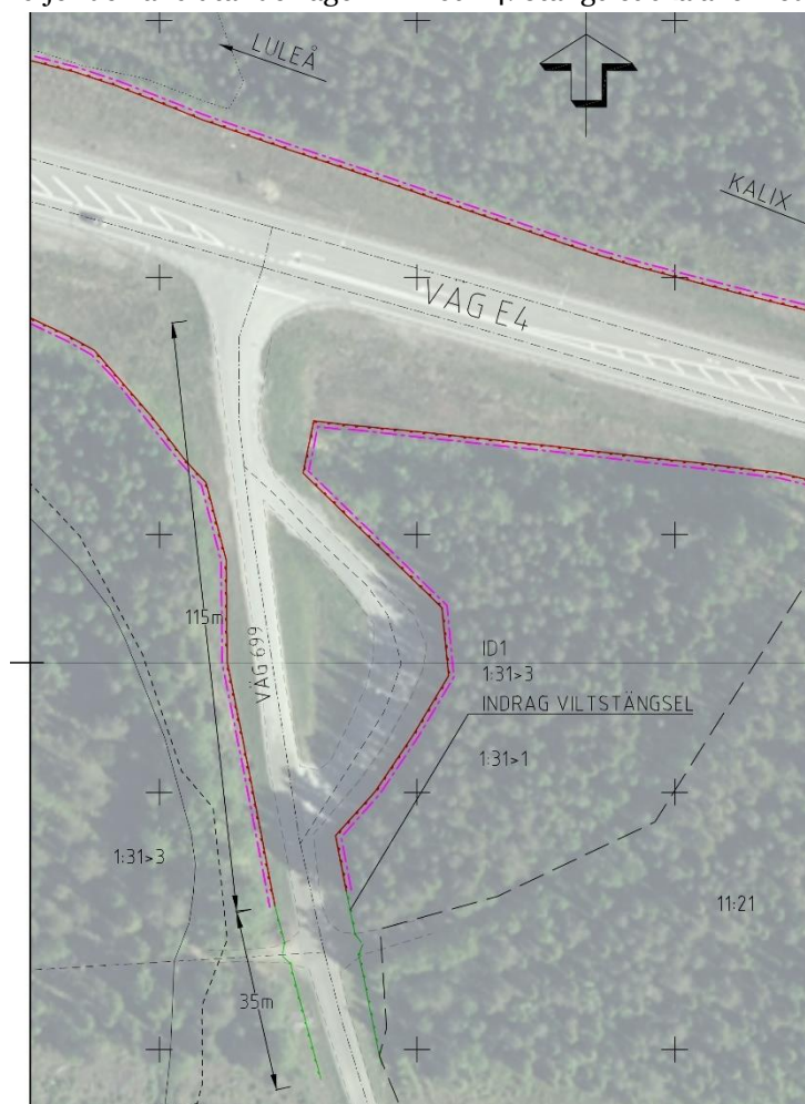
Figur 18. Illustration som visar hur indragning av stängsel vid allmän eller enskild väg med frekvent trafik kan utföras, utdrag från illustrationskarta.
