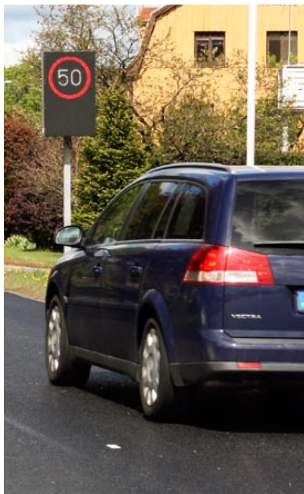
Figur 7.1.3 ITS-lösning med hastighetspåminnande information
