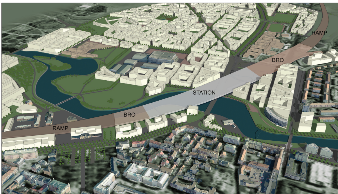
Figur 4.3 Idéskiss som visar en schematisk volym av Ostlänken på bro genom centrala staden över Stångån. Innerstadens utveckling påverkas direkt och indirekt av bron. Årummet förändras i karaktär.
