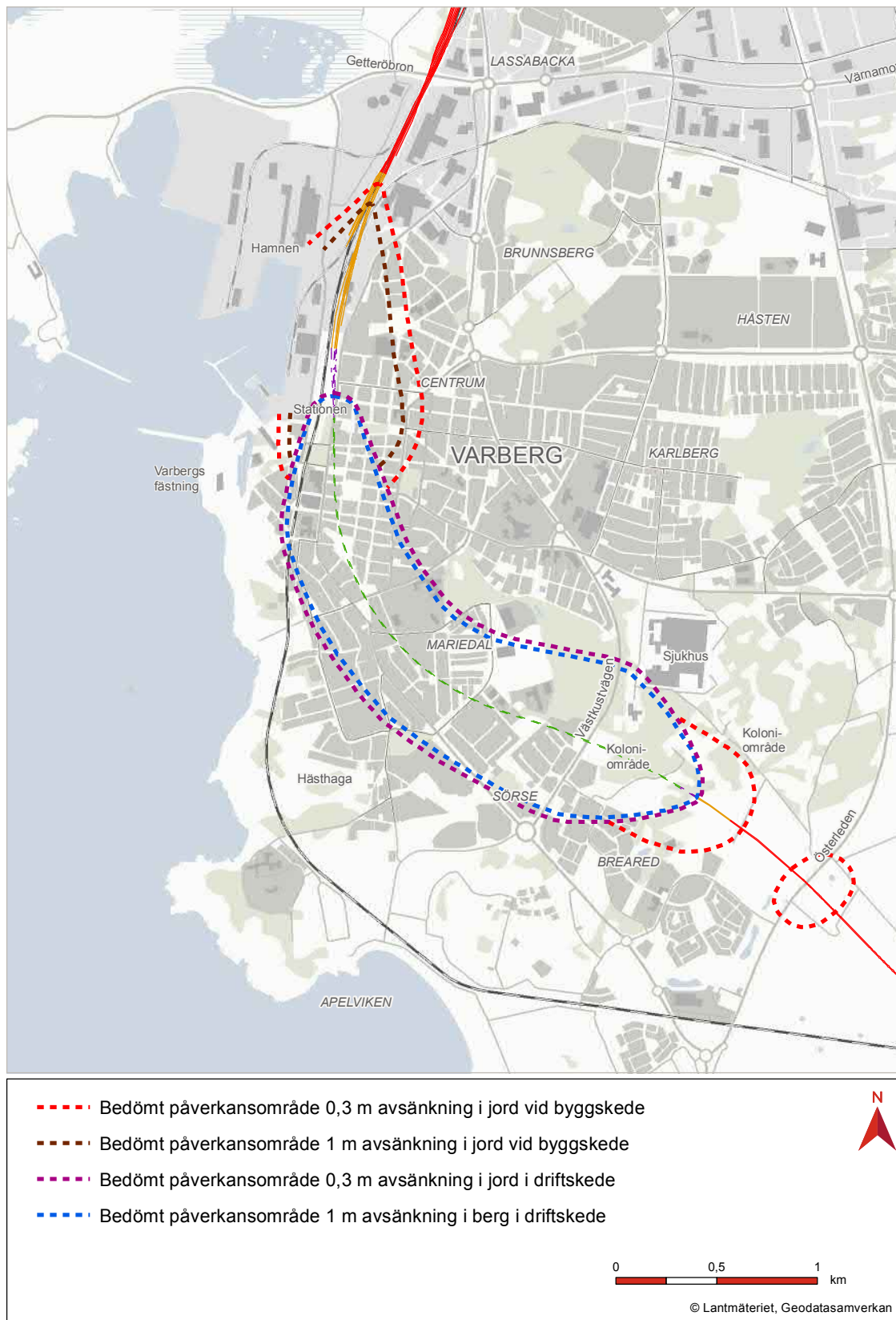
Figur 18.1 Översiktligt, preliminärt bedömt påverkansområde för byggskede tråg och betongtunnel samt områden söder om betongtunnel (mer än 0,3 meter avsänkning i jord), samt bygg- och driftskede bergtunnel (mer än 1 meter avsänkning i berg och mer än 0,3 meter i jord).
