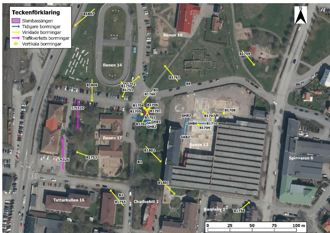
Figur 5. Översikt av utförda bergborrningar inom och kring Kv Renen (se även Figur 6 ). Entreprenadförberedande borrningar är markerade med gult och tidigare borrningar med blått.
