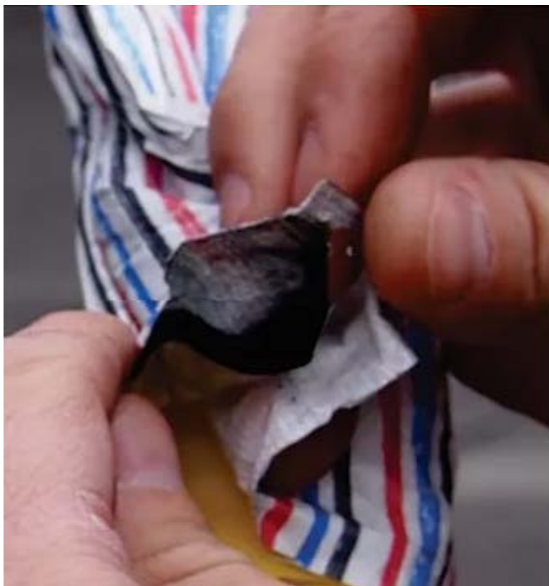
Figur 9. Kolremsan fastsatt mellan indikatorstyget och linern.
