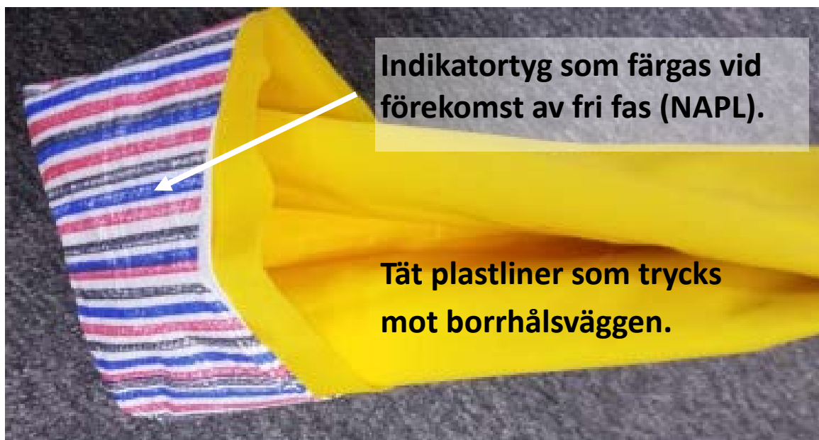
Figur 8. Liner med indikatorstyck på utsidan. Tyget trycks mot bergväggen i borrhålet och färgas vid ev. förekomst av fri fas förorening. Tyget påverkas inte av lösta föroreningar i vattenfasen.
