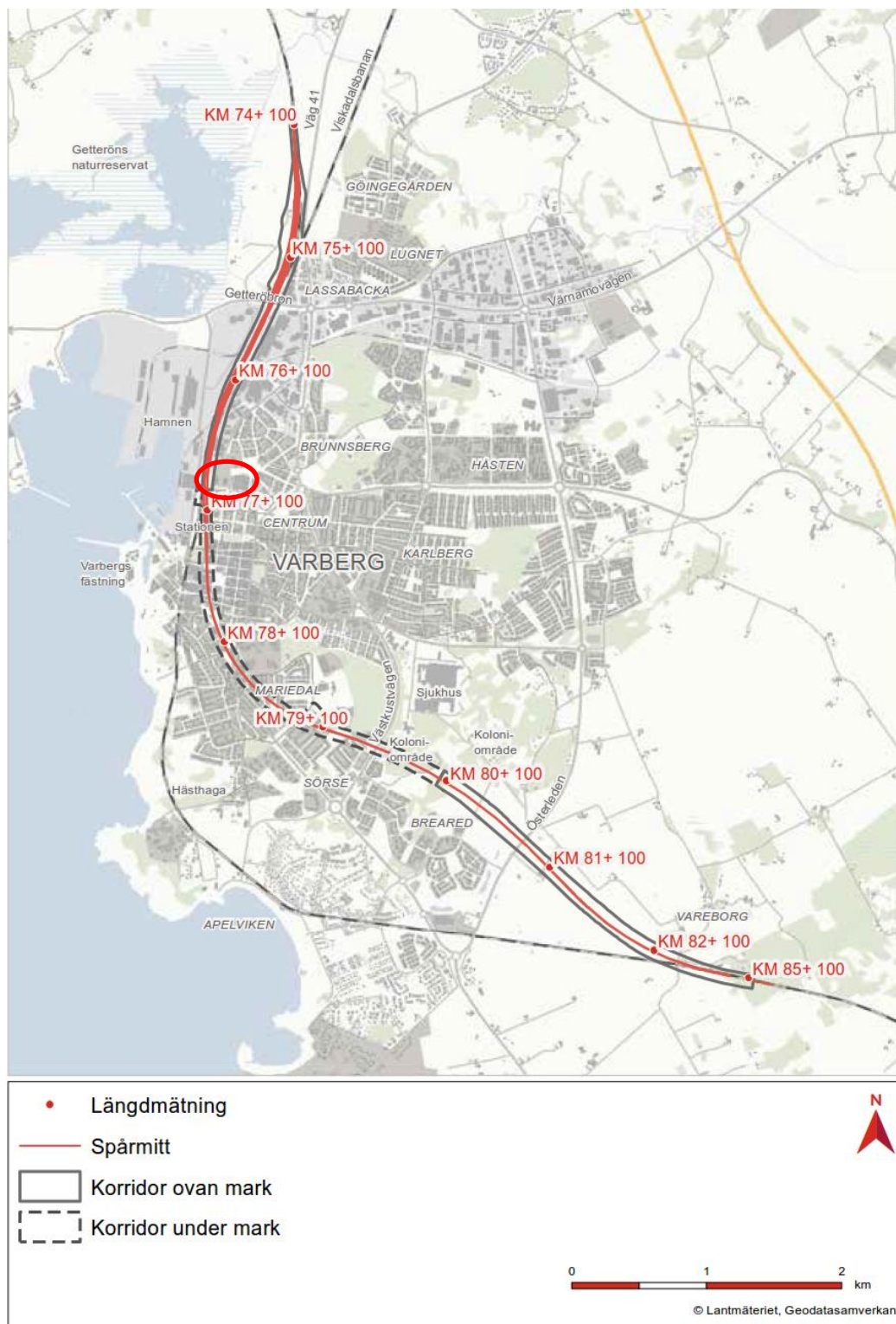
Figur 2-1. Översiktskarta, tillåtighetskorridor med inritad järnvägslinje. Utbyggnaden omfattar ca 9 km ny järnväg, där ca 3 km går i tunnel. Röd cirkel visar läget på Kv Renen.
