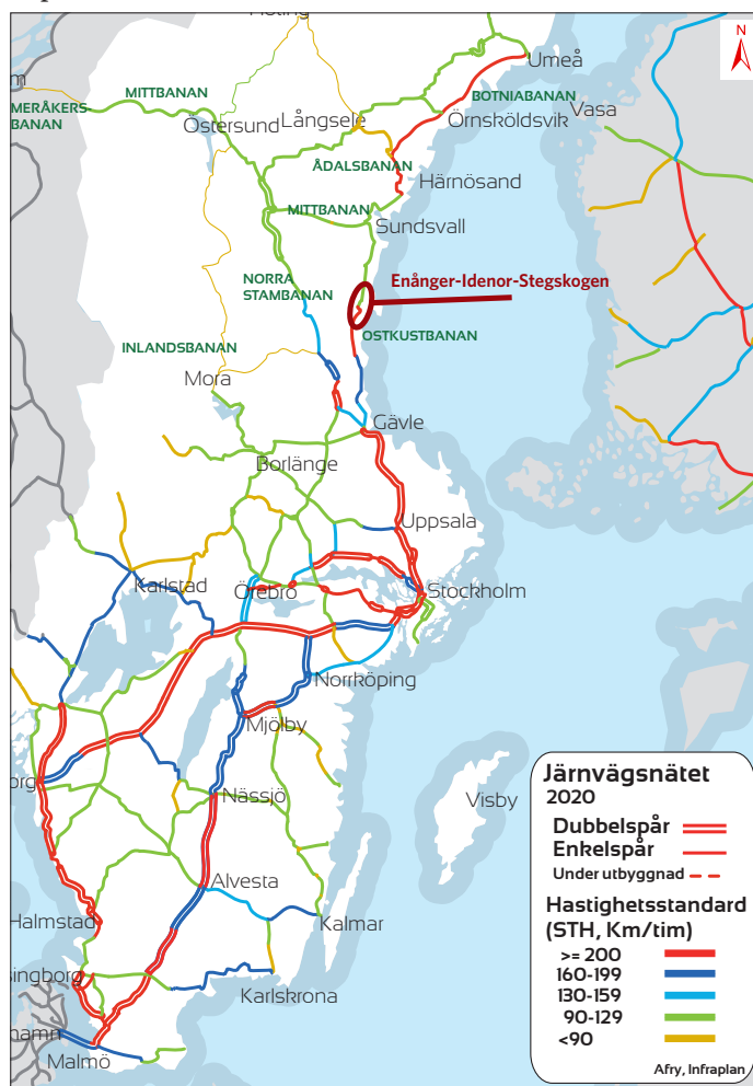
Figur 4.1:1 Ostkustbanan är enkelspårig och delvis låg hastighetsstandard.
