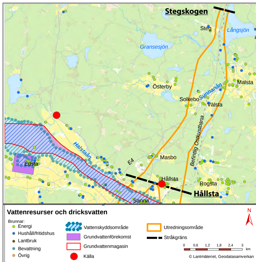
Figur 4.7:33 Källor och brunnar enligt SGU:s brunnarsarkiv inom eller i anslutning till delsträckan Hållsta-Stegskogen.
