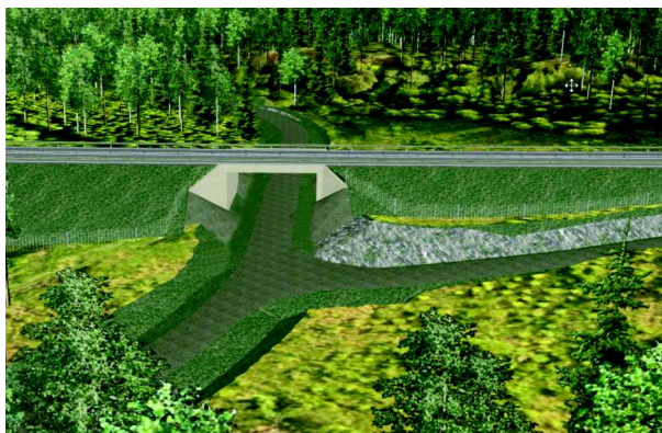
Viltanpassad port vid km 1/470.
