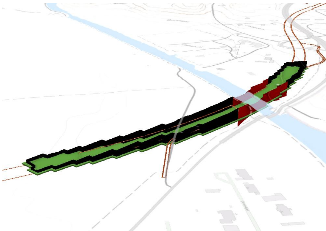
Figur 24. Anläggningens utformning enligt huvudalternativet. Tätkakan (grön) är en meter tjock och följer schaktbotten. En del av sponten är svävande (svart) är nedslagen tre meter under schaktbotten. Där bergöverytan bedöms tillräckligt nära den planerade anläggningen, mellan sektion 7/660-7/780 går sponten ner till berg (mörkröd).
