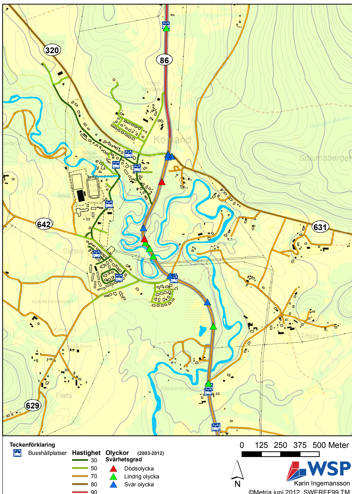
Figur 4.11. Hastigheten är 70 km/h på väg 86 förutom under skolvermenerna då hastigheten sänks till 50 km/h förbi korsningen med väg 629). Två dödsolyckor och flera allvarliga olyckor har skett utmed sträckan de senaste tio åren.
