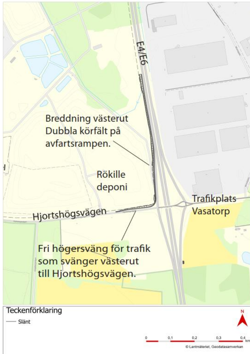
Figur 24. Principiell illustration av trimningsåtgärd i trafikplats Vasatorp.
