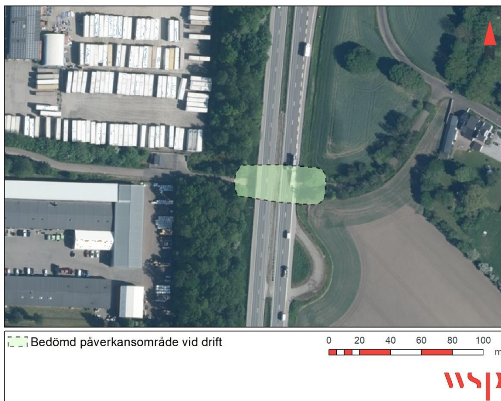
Figur 31. Bedömning av påverkansområde (0,1 meter avsänkning) till följd av tillkommande grundvattensänkning vid rörbron under driftskedet.
