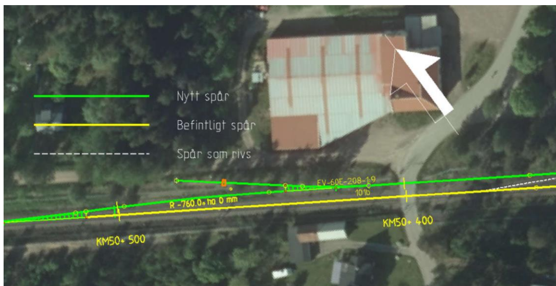
Figur 20 Mötesstationen förlängs västerut över befintlig plankorsning vid Morbyvägen som ersätts med GC-tunnel för gång- och cykeltrafik under järnvägen. Bild Atkins.
