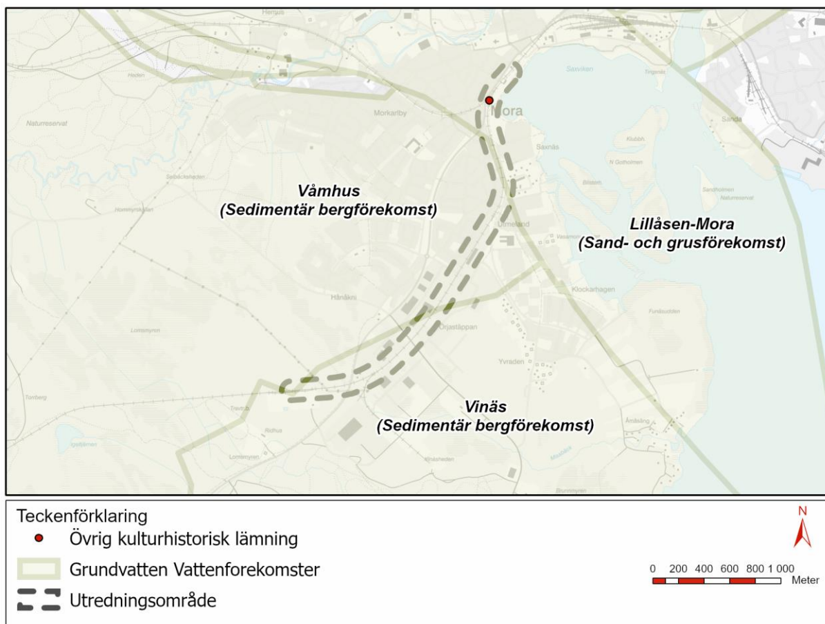
Figur 4. Grundvattenförekomster som berör sträckan och övrig kulturhistorisk lämning.
