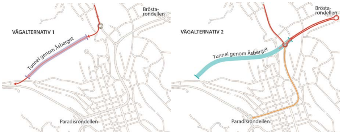
Figur 5.17 Skillnad i färdväg mellan alternativ 1 och alternativ 2 i ett exempel för en bil från Gullänget eller Björna som ska köra E4 söderut. Vid cirkulationsplatsen vid Björnavägen måste bilisten i alternativ 2 ta E4 norrut och vända i Bröstarondellen för att ansluta till tunneln och vidare färd på E4 söderut. Orange pil i högra kartan visar hur långt samma bil kommer vid färd genom centrum i stället för att vända i cirkulationsplatsen. Se även bilaga 7 för stor karta.
