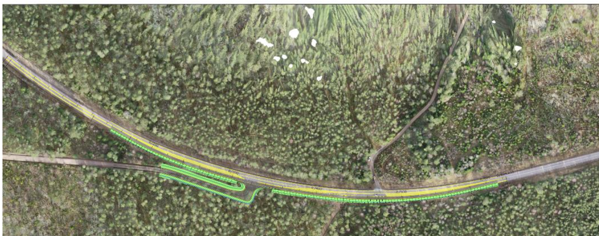
Figur 4 Skiss fokusområde 1 – korsningsåtgärder. Grönt avser ungefärlig släntutbredning på ny utformning, gult avser målning och kantlinjer på befintlig väg.
