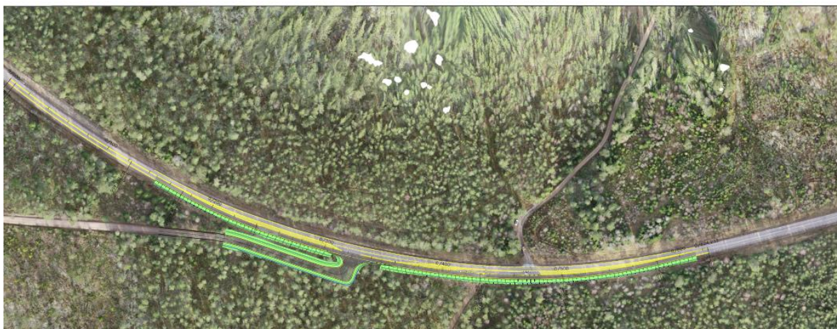
Figur 3. Skiss fokusområde 1 – korsningsåtgärder. Grönt avser ungefärlig släntutbredning på ny utformning, gult avser vägmarkering med spärrfält på ny väg.
