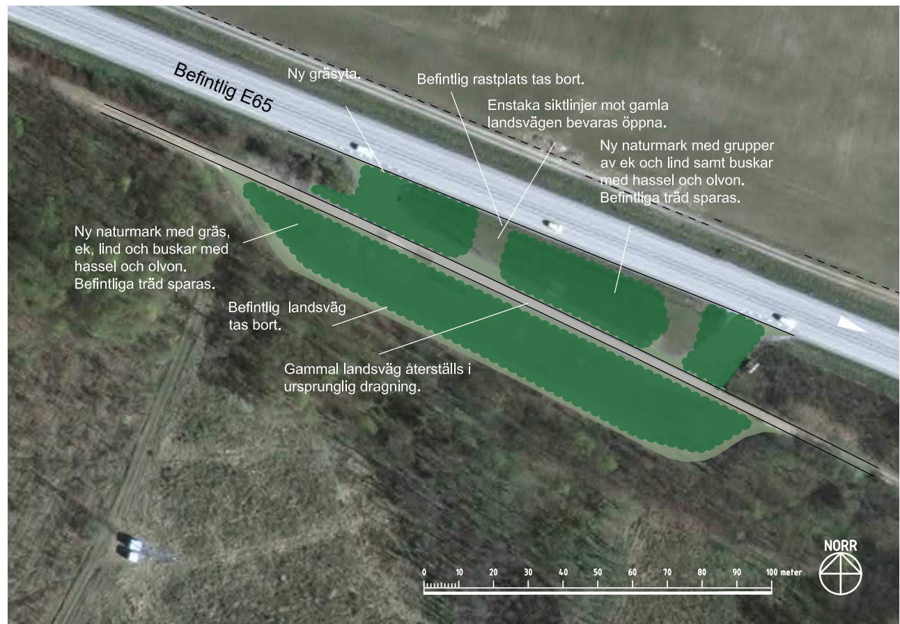
Figur 33. Den befintliga rastplatsen tas bort och landsvägens ursprungliga sträckning återställs.
