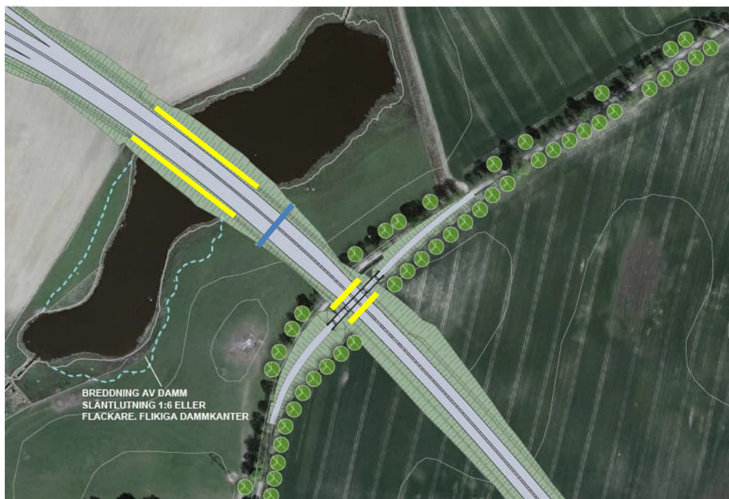
Figur 74. Illustration på åtgärder vid dammen och Håkanstorpsbron. Gul linje visar föreslagen placering av bländskydd, blå linje visar torrtrumma och gröna prickar visar återplantering i Håkanstorpsallén. Observera att placering av åtgärder är ungefärliga.
