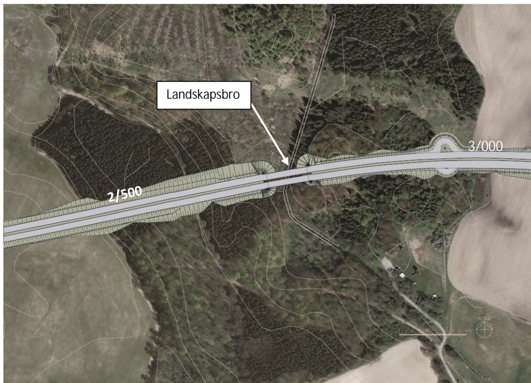
Figur 13. Placering för vägbro över ravinen utformad som landskapsbro väster om väg 813 (Sturupsvägen).
