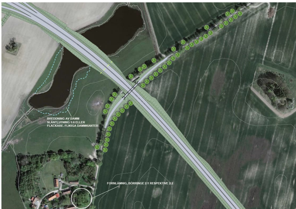
Figur 55. Håkanstorpsvägen leds över ny E65 på bro. Håkanstorpsallén förstärks genom plantering i befintliga luckor. Observera att placering av trädmarkeringar är en illustration.
