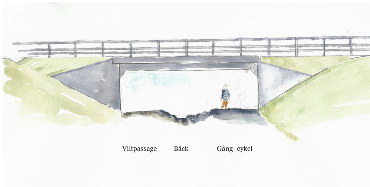
Figur 23. Elevation gång- och cykelpassage/faunapassage Nedre Läsarbo.
