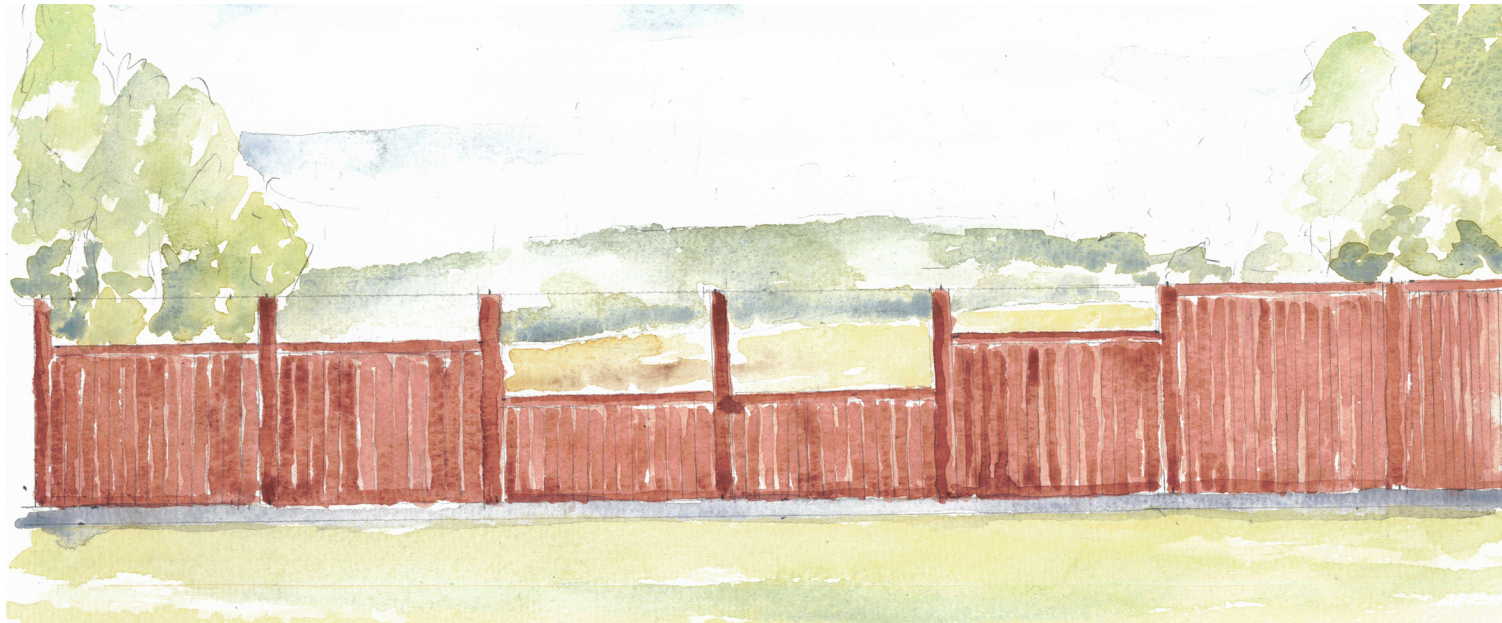
Figur 25. Principelevation bullerskyddsskärmar med genomsiktliga partier.
