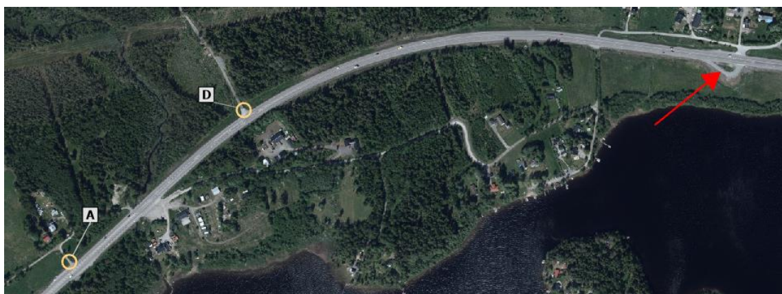
Figur 11. Visar vändmöjlighet norr om anslutningsvägarna A och E4/Krånge (D) (markerade med cirkel) och utgörs av en ögla för vänstersväng (markerad med pil).
