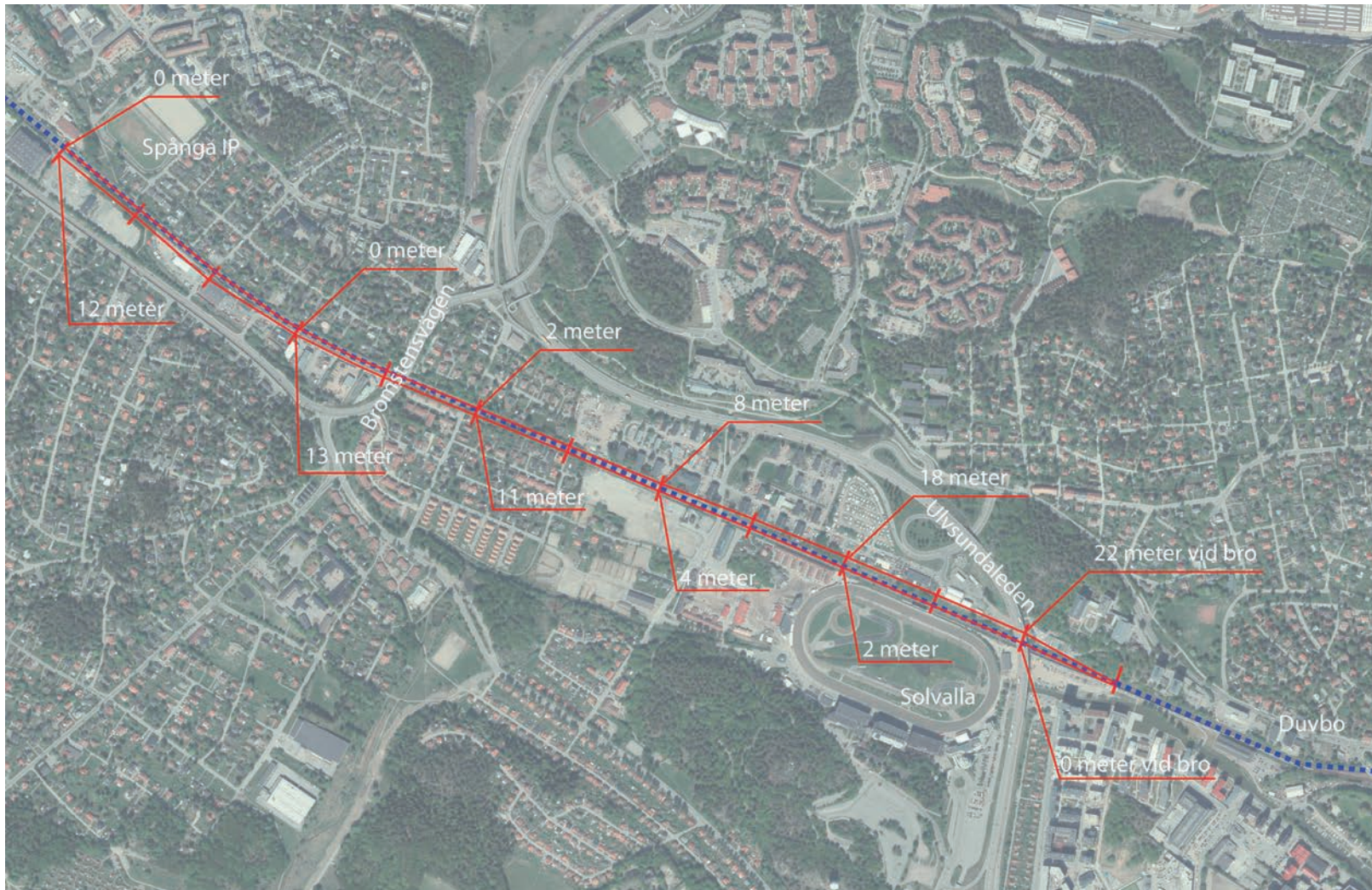
Figur 23. Figur som schematiskt visar den ungefärliga breddningen av spårområdet, från Duvbo mot Spånga (rödmarkerad sträcka). De siffror som redovisas i figuren anger breddningen av spårområdet söder ut respektive norr ut jämfört med dagens spårområde.
