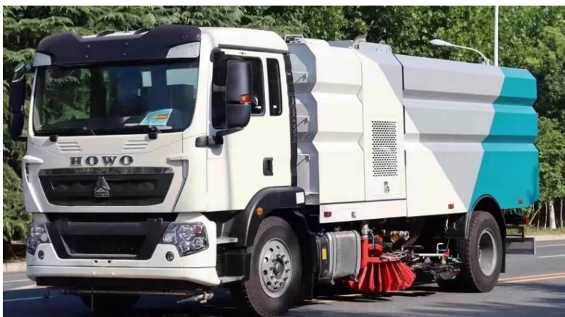
Figur 1 Exempel på en sopbil som används för att rengöra hårdgjorda ytor.
