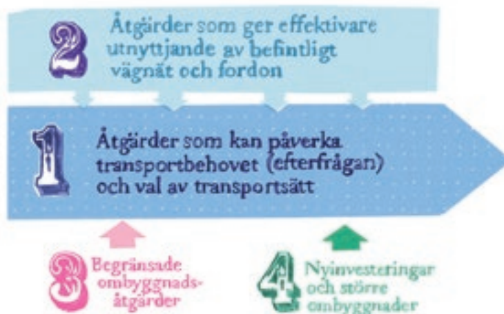
Figur 7. Ett kontinuerligt arbete med verksamheter och projekt i fyrstegsprincipens steg 1 och 2 minskar behovet av åtgärder i steg 3 och 4.
