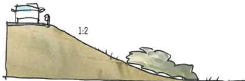
Figur 10. I en bankslänt bör eventuell plantering göras vid bankens fot, inte längre än halvvägs upp på slänten.
