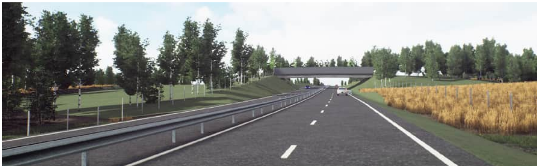
Figur 42. Ekodukten sedd från öster. Landskapsanpassning görs genom att naturliga höjder i landskapet byggs på så att ekoduktens båda ändar förankras väl i omgivningen. Planteringar och andra anpassningar görs enligt Figur 43.
