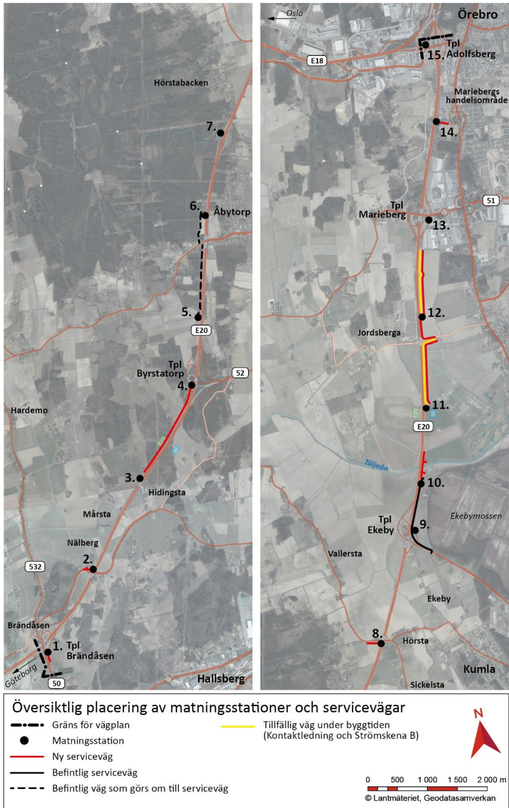
Figur 22. Karta som visar översiktlig placering av servicevägar för åtkomst till matningsstationerna.
