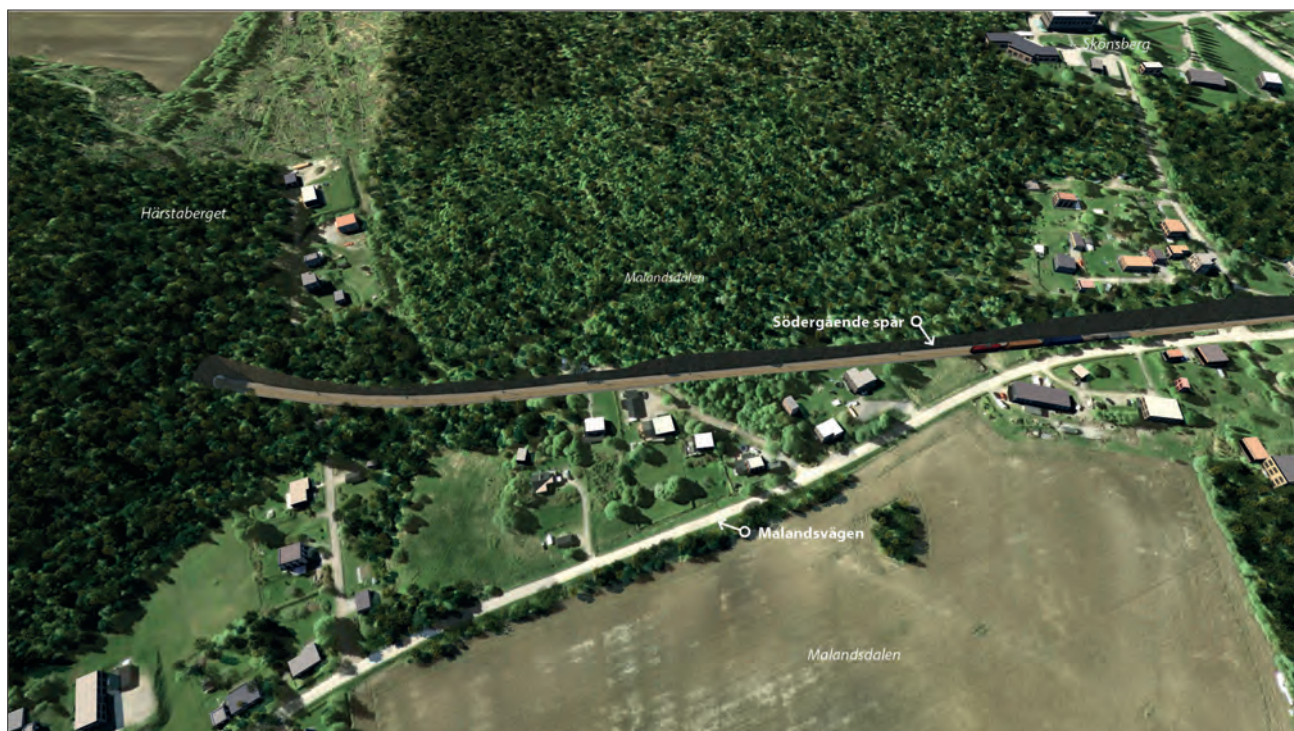
Figur 7.3:13 Maland A Kort tunnel, fågelvy mot Härstaberget över västra tunnelpåslaget. Skärningen lämnar boendemiljöerna i den östra delen mot tunnelpåslaget relativt intakt. I väster skapas en kraftig barriär mellan bebyggelsen mot Malandsvägen. Vy nr 9 genererad ur samrådsmodell. Notera att den illustrerade bergskärningen kommer att ges en större utbredning när hänsyn tas till överliggande jordlager, behov av överdiken mm.
