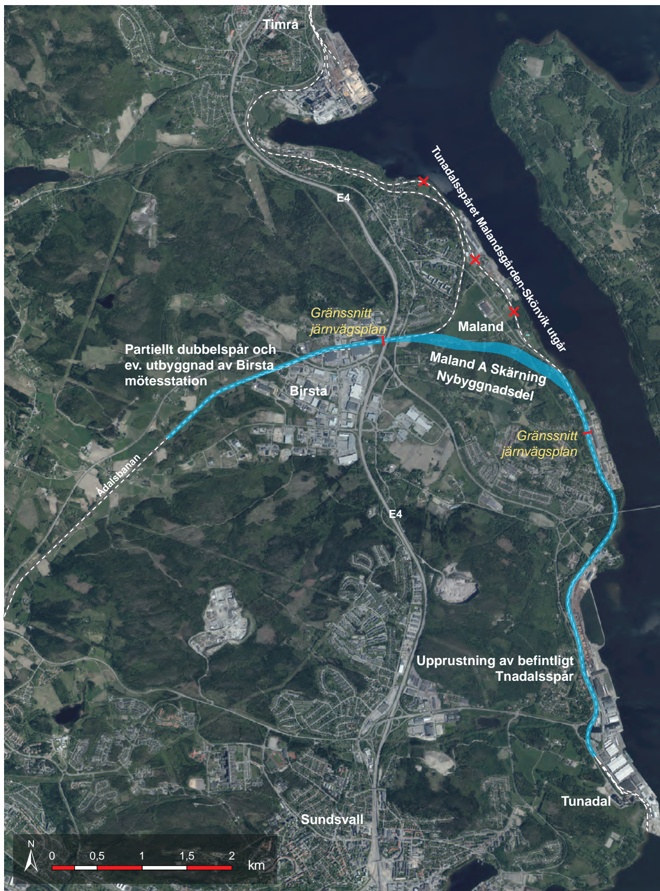
Figur 1:6 Föreslagen helhetslösning: Maland A Skärning och tredje mötesspår på Birsta mötesstation. Befintligt Tunadalsspår utgår på delen Malandsgården-Skönvik.
