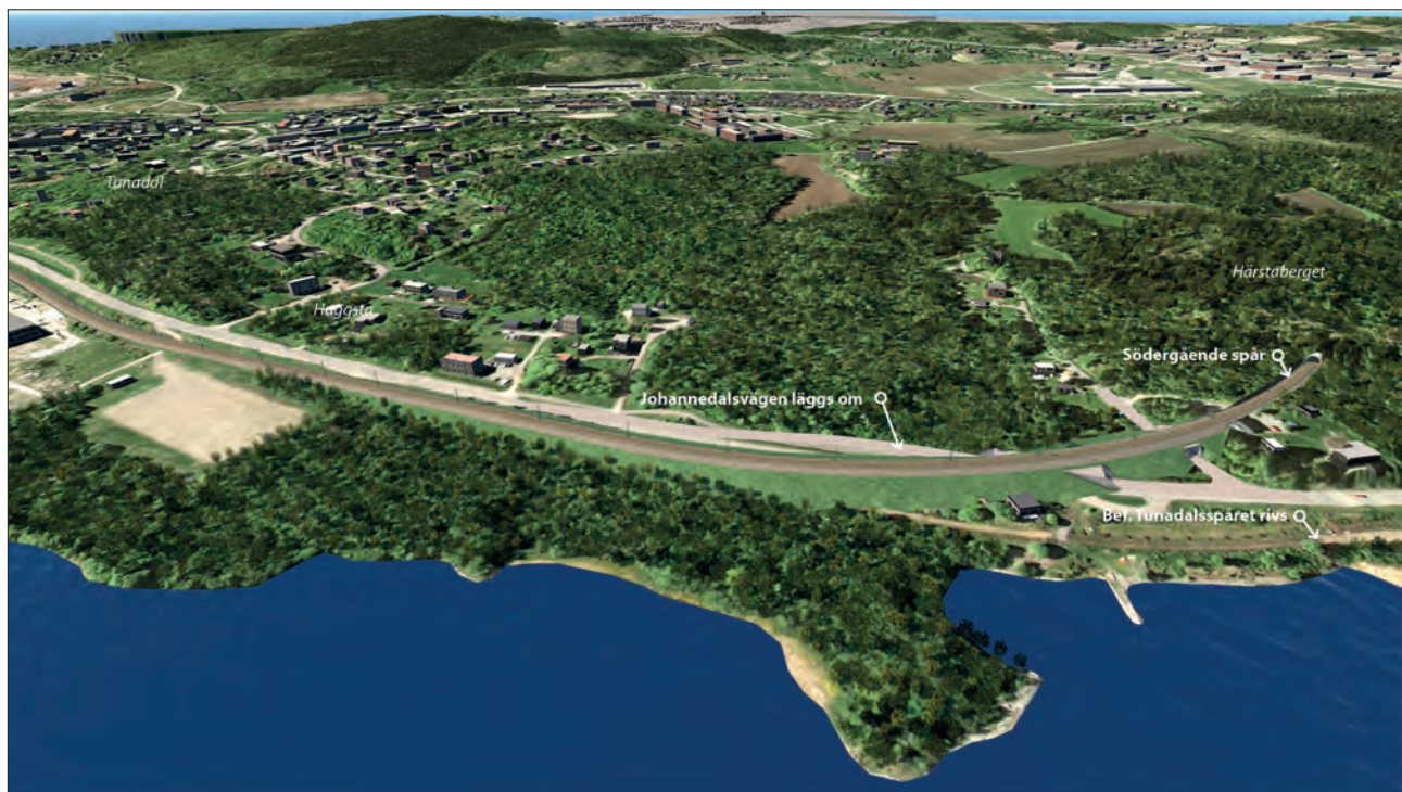
Figur 7.3:14 Maland A Kort tunnel, fågelvy mot Härstaberget över östra tunnelpåslaget. Söder om tunnel-påslaget övergår skärningen i en hög bank över Johannedalsvägen som behöver läggas om. Vy nr 10 genererad ur samrådsmodell.
