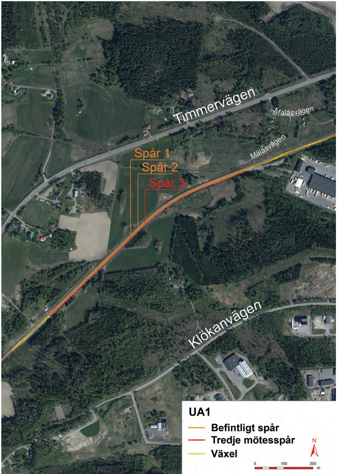
Figur 4.2:3 UA1 Tredje mötesspår vid Birsta mötesstation
