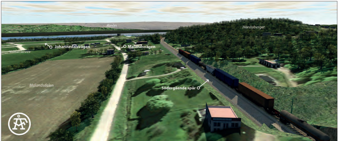
Figur 7.3:7 Maland A - Skärning, berg- och jordskärning längs Malandsvägen, vy mot öster och Alnösundet. Intrång sker i närmiljöer till fastigheter. Lokalvägar blir avskurna. Vy nr 5 genererad ur samrådsmodell.
