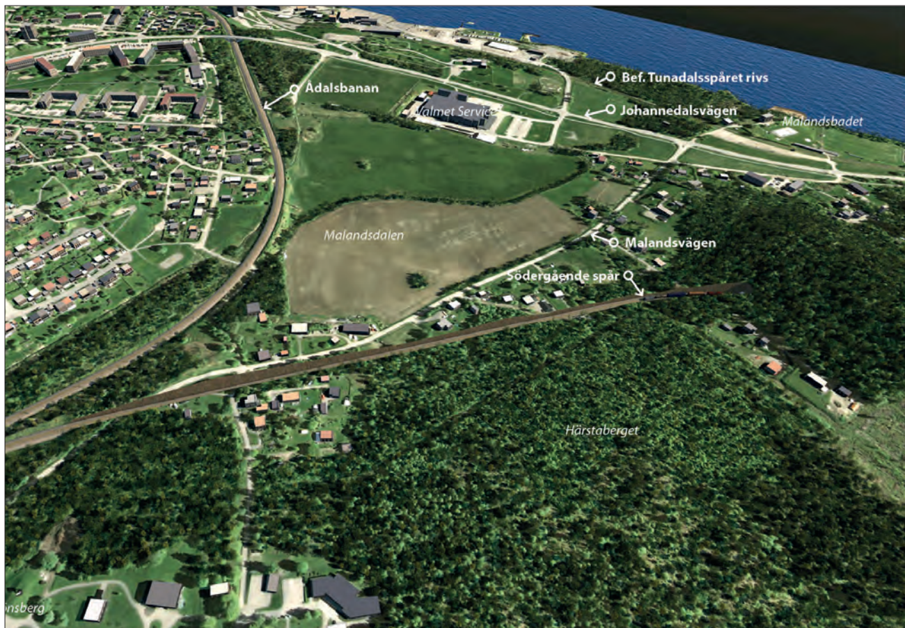
Figur 7.3:11 Maland A Kort tunnel, fågelvy av västra tunnelpåslaget över Härstaberget. Större delen av dalen lämnas intakt. Intrång i gårds- och boendemiljöer begränsas. Vy nr 7 genererad ur samrådsmodell. Notera att den illustrerade bergskärningen kommer att ges en större utbredning när hänsyn tas till överliggande jordlager, behov av överdiken mm.
