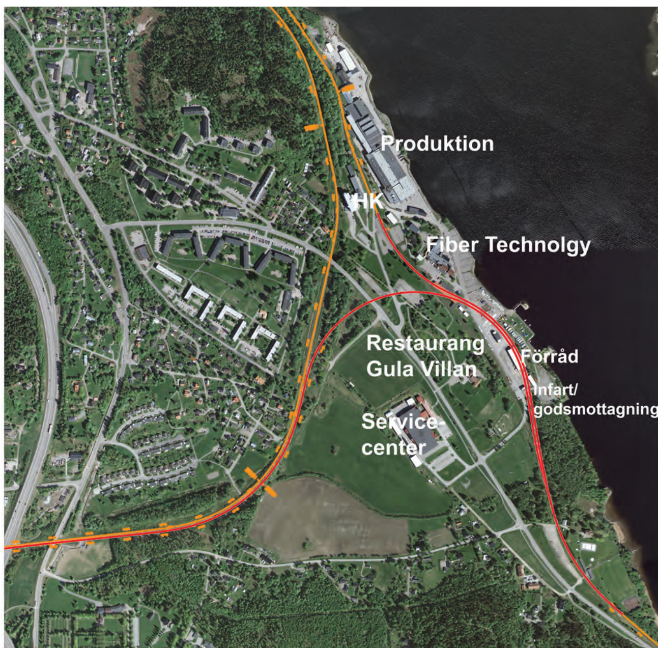
Figur 5.2:6 Ett nordligare läge för södergående spår Maland B, med horisontalradie av 300 meter innebär ett stort och påtagligt intrång i Valmets verksamhetsområde. Ett norrgående spår via befintligt Tunadalsspår skulle ytterligare och på ett påtagligt negativt sätt förstärka barriärverkan i verksamhetsområdet. Därtill erfordras partiellt dubbelspår längs Ådalsbanan, vilket skulle ge intrång i en av de befintliga Kungshögarna. Den skisserade sträckningen är inte aktuell för fortsatta studier.
