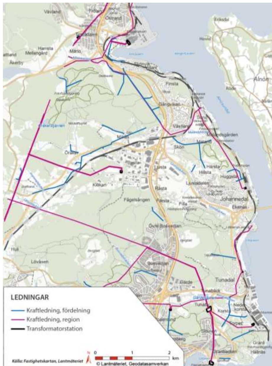
Figur 2.8:1 Kraftledningar och transformatorstationer.
