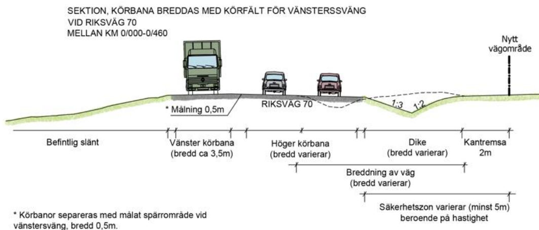
Figur 26. Förslag på typsektion 3 väg 70.
