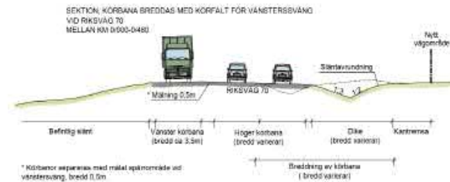
Typsektion C, visar väg 70 västerut med breddning av väg i form av vänstersvängskörfält.
