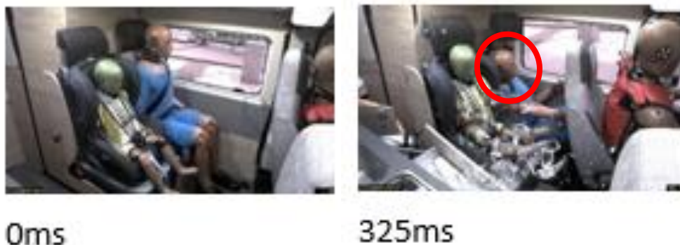
Figur 8. Bakre radens passagerare i krockprov, före och efter krock (ADAC, Tyskland 2020)
