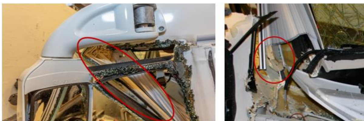
Figur 7. Detaljbilder av A-stolpe på krockad helintegrerad husbil, ovandel till vänster, nederdel till höger.
