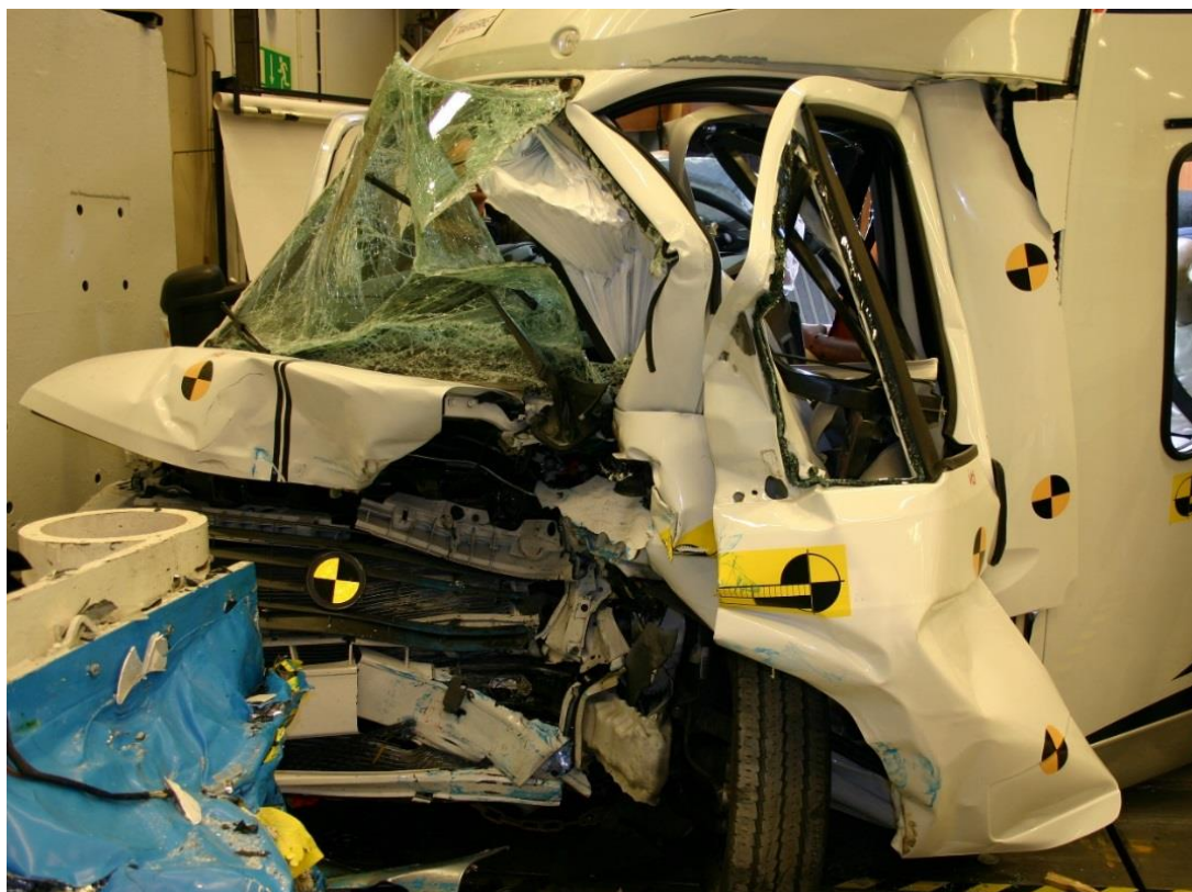
Figur 5. Halvintegrerad husbil i krocktest i 64 km/h mot fast deformerbar barriär (Trafikverket 2019)
