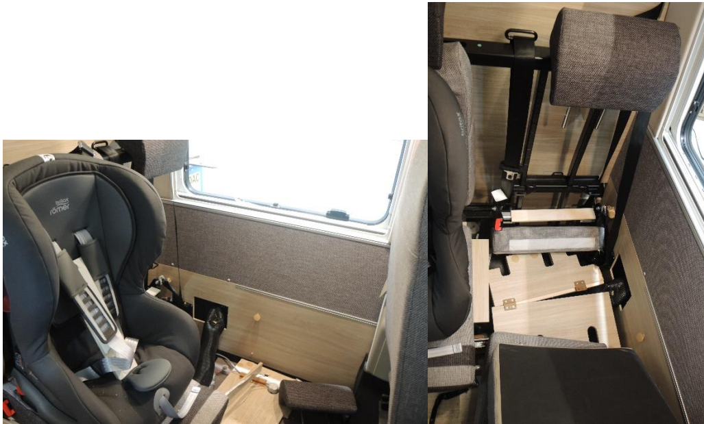
Figur 9. Stolsdynans kollaps efter krockprov (ADAC, Tyskland 2020)
