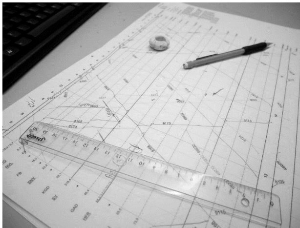
Figur 6. Bilden visar hur avgångs- och ankomsttider räknas fram. Detta sker med hjälp av papper, penna och linjal. Fotograf: Göran Fält, Trafikverket.
