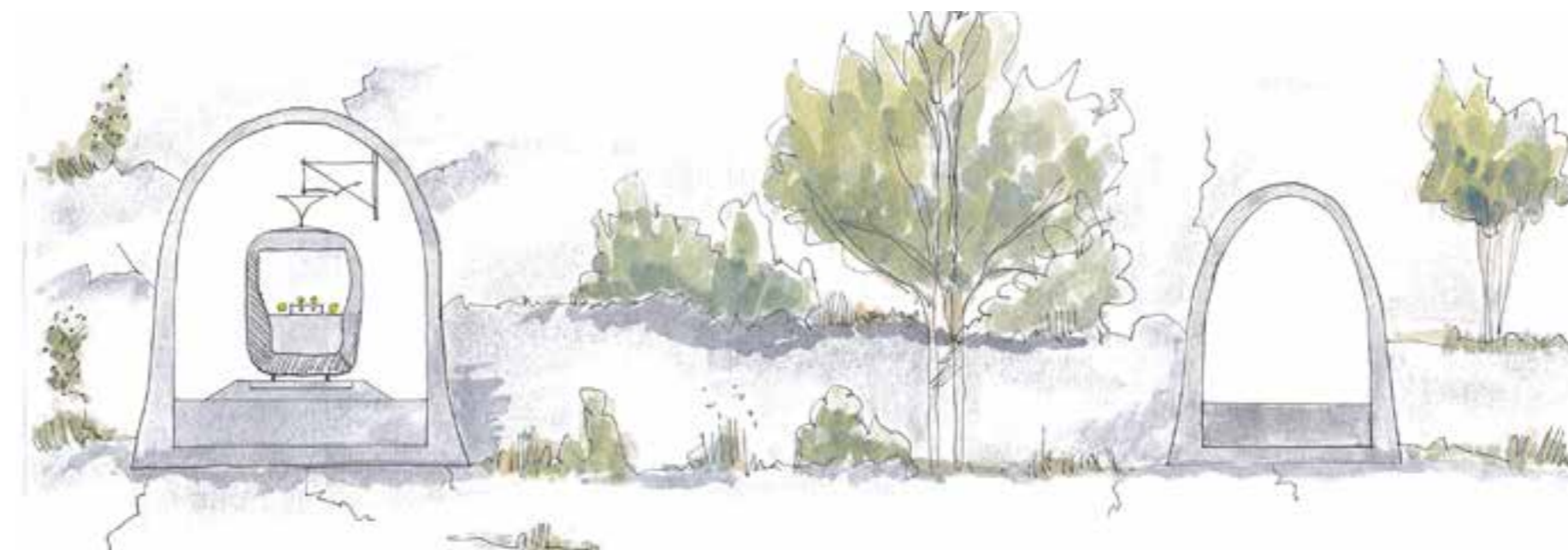
Figur 4.2.2 Illustration tunnel, enkelspår, med intilliggande räddningstunnel.
