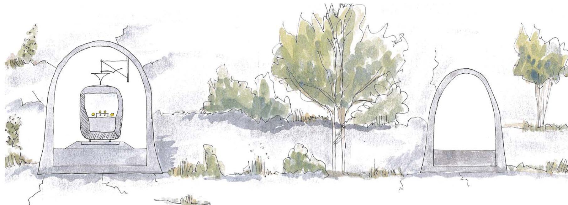
Figur 4.9.5 Enkelspår med tillhörande räddningstunnel, vars mynning senare i framtiden kan utvidgas och användas för ytterligare ett spår.
