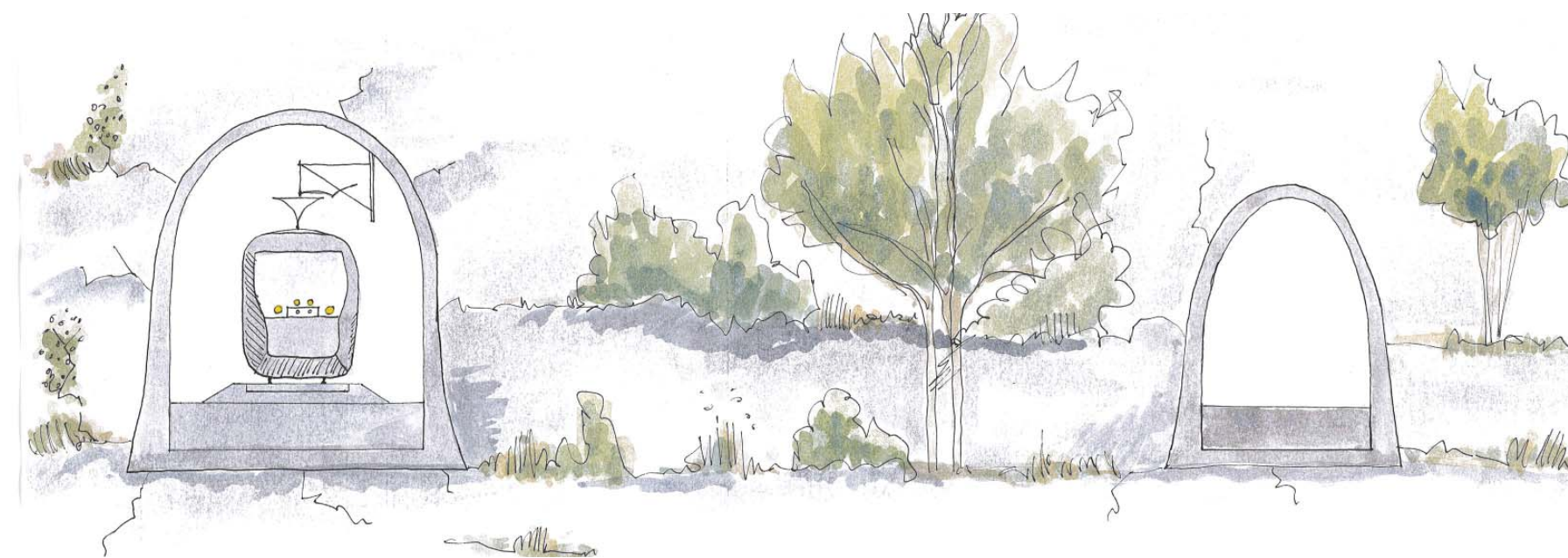
Figur 4.2.2 Illustration tunnel, enkelspår, med intilliggande räddningstunnel.
